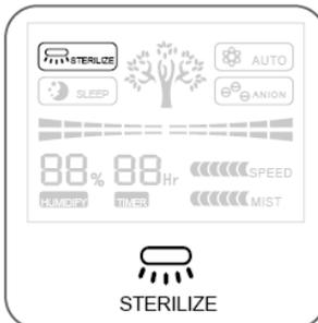
Drücken Sie die Taste "Sterilisieren", um das UV-Keimtötungslicht einzuschalten; das Symbol wird auf dem Display angezeigt. Wenn es eingeschaltet ist, wird die intelligente Sensorsteuerung automatisch zur gleichen Zeit eingeschaltet.
