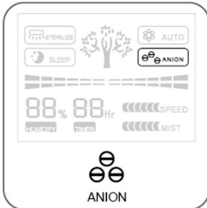
Drücken Sie die Anionentaste, um den Anionengenerator einzuschalten. Wenn er eingeschaltet ist, wird das Symbol auf dem Display angezeigt. Die intelligente Sensorsteuerung wird gleichzeitig automatisch eingeschaltet.
