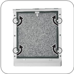
Drehen Sie die Schnallen und entfernen Sie beide Filterteile.
