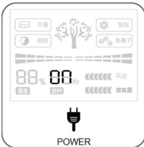
Das Produkt wird eingeschaltet, der digitale Bildschirm zeigt "ON" an, und das Gerät befindet sich im Standby-Modus.
