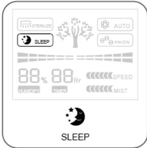
Wenn Sie auf die Schlaftaste drücken, befindet sich das Gerät auf niedriger Geschwindigkeit und die intelligente Sensorsteuerung ist ausgeschaltet. Die Geschwindigkeits- und Schlaftasten werden in einer sich gegenseitig ausschließenden Weise gesteuert. Wenn eine eingeschaltet ist, ist die andere ausgeschaltet.
